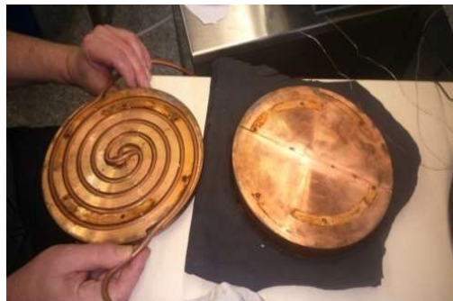
Figure 2.5. Plaque de refroidissement montrant un tube en serpentin
