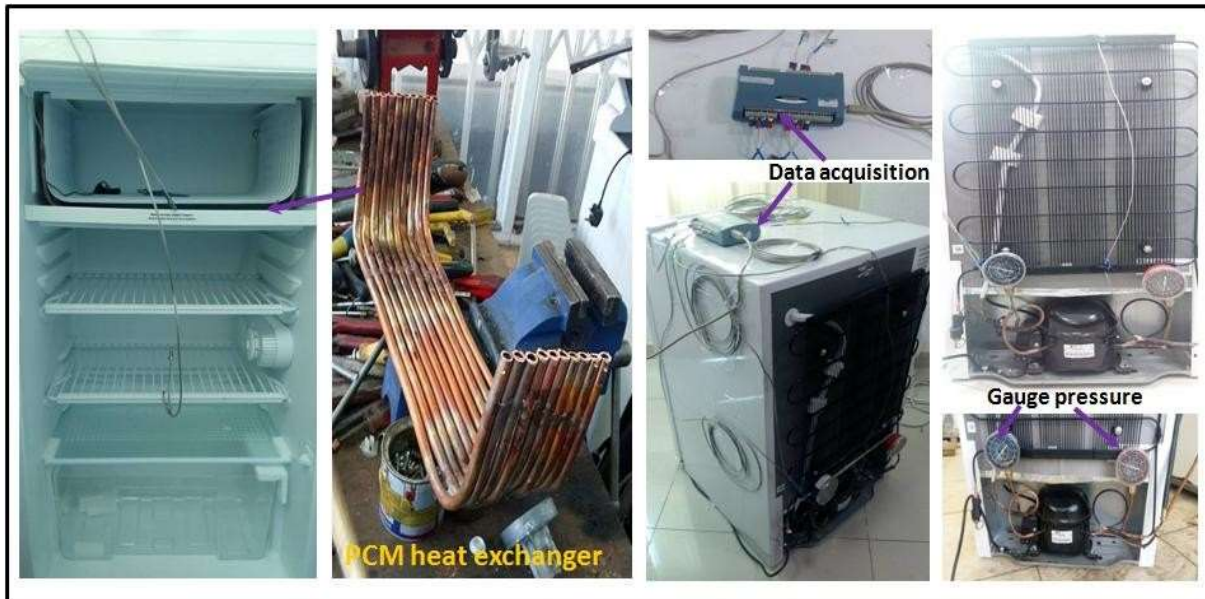
Figure 3.2. Photo de matériels expérimentaux utilisés (le réfrigérateur domestique avec l'échangeur de chaleur à MCP.
